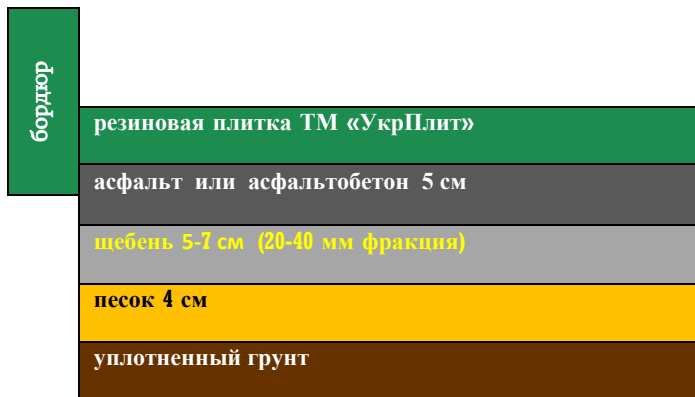
Рис.2 – Подготовка основания для укладки резиновой плитки на асфальт:
